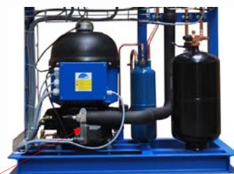
Pos. 4/1 Bild 4: Halboffener Trennhaubenverdichter Fig. 4: Semi-Open Separating Hood Compressor
